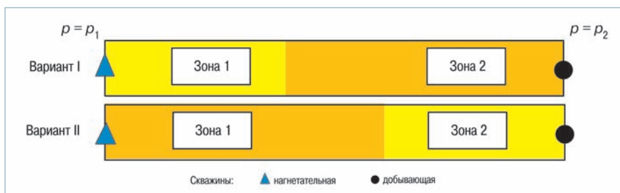
Рис. 1. Схематическое представление задачи о вытеснении нефти водой из зонально-неоднородного пласта при заданном перепаде давления \Delta p = p_1 - p_2 : p_1, p_2 – давление соответственно в зоне нагнетания и отбора
