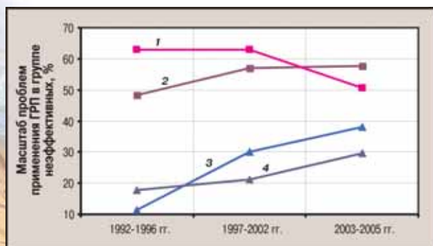
Рис. 3. Динамика масштаба проблем применения ГРП по результатам автоматизированной нейросетевой экспертизы: 1 – низкий прирост дебита жидкости; 2 – снижение дебита жидкости после ГРП; 3 – резкий прирост обводненности после ГРП; 4 – рост обводненности после ГРП
